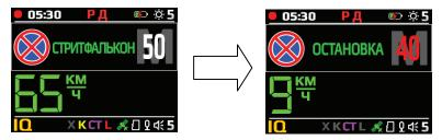
Следует отметить, что в случае движения в такой зоне с низкой скоростью (менее 10 км/ч), которая может быть свидетельством возможного намерения совершить остановку или припарковаться, прозвучит предупредительный звуковой сигнал. Отключить оповещения о контроле стоянки и остановки можно в пункте меню "Объекты контроля БД" -> КП -> Выкл.
