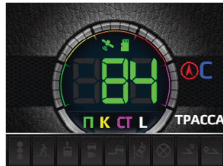
**Сигнатурный фильтр "Подпись" (П):** Сигнатурная технология предназначена для существенного снижения количества ложных оповещений путем распознавания сигнала радара, а также распознавания и фильтрации сигналов вспомогательных систем современных автомобилей.
